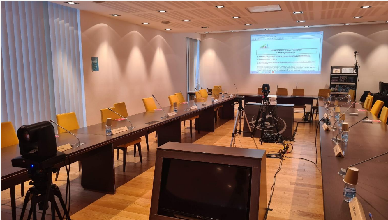
Captation vidéo avec 2 caméras PTZ et 2 caméras fixes (dont 1 grand angle)
